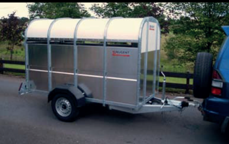
Bétailière à simple essieu, ouvertures latérales d'aération
