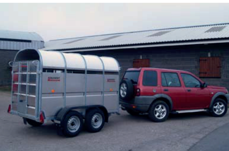
Bétailière à double essieux, et hayon d'embarquement
