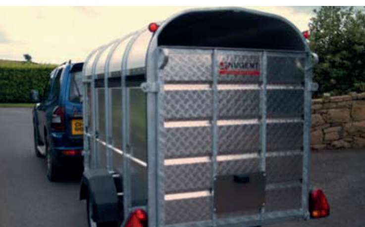
Bétailière à double essieux, et hayon d'embarquement
