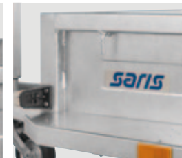
6 Caisse entièrement galvanisée (de série)
